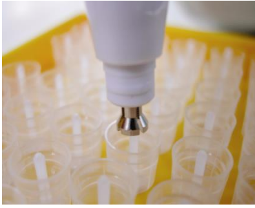
Figura 1: La punta del tip metálico de la pipeta está correctamente extendido.
