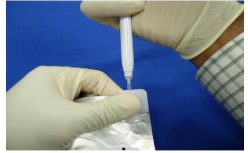
Figura 3: Inserción del tip de plástico lleno de muestra en el puerto de inyección.
