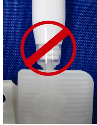
Figura 5: Tip de plástico incorrectamente asentado en el puerto de inyección.
