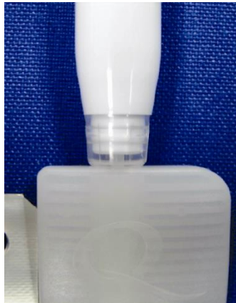
Figura 4: El Tip de plástico correctamente asentado en el puerto de inyección.
