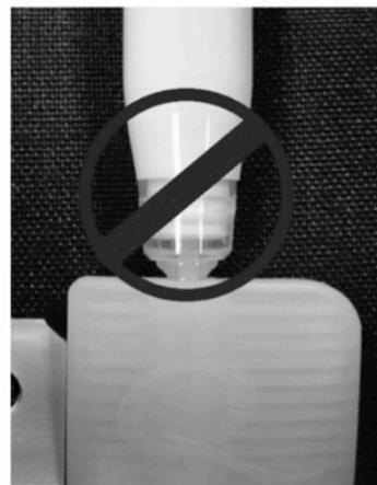
**Figure 5:** Embout de la pipette mal inséré dans l'orifice d'injection.
