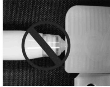
**Figure 5:** Embout de la pipette mal inséré dans l'orifice d'injection.
