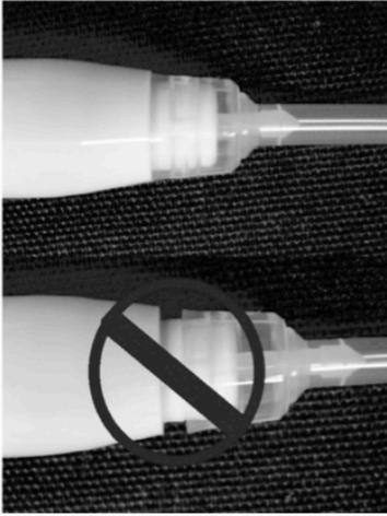
**Figure 2:** Embout INCORRECTEMENT et CORRECTEMENT posé sur la pipette.
