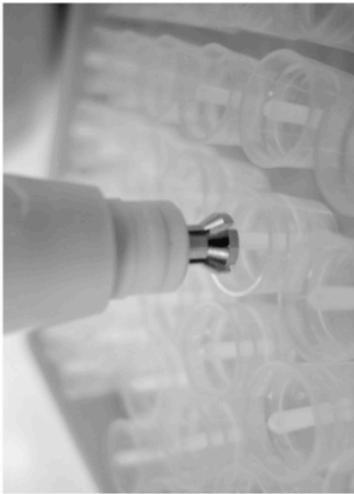
**Figure 1:** Bout métallique de la pipette sorti pour saisir le piston de la pipette.
