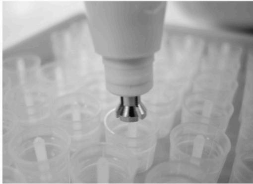
**Figure 1:** Bout métallique de la pipette sorti pour saisir le piston de la pipette.
