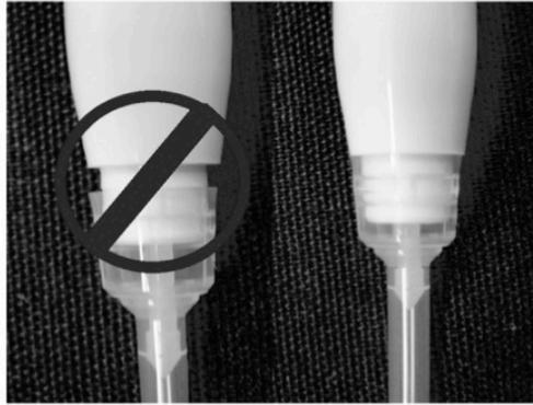
**Figure 2:** Embout INCORRECTEMENT et CORRECTEMENT posé sur la pipette.
