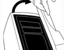
**13.** Ouvrir la porte de l'analyseur lorsque le test est terminé. Enlever le FastPack® IP et inscrire les résultats sur l'étiquette jointe.
