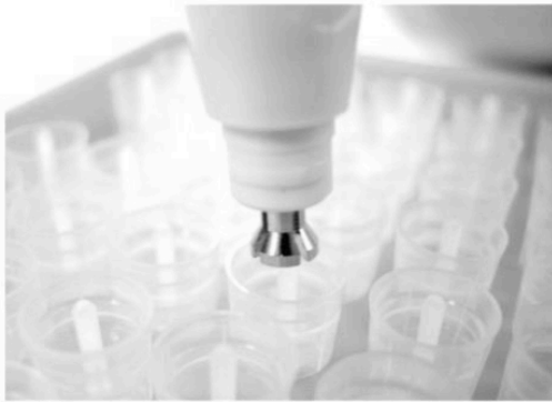
Figur 1: Metallspets utsträckt för att gripa pipettkolven.
