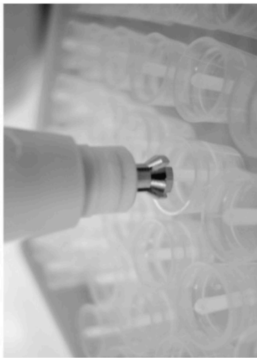
Figur 1: Metallspets utsträckt för att gripa pipettkolen.
