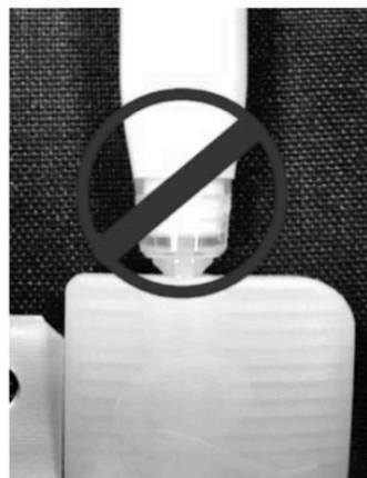
Figur 5: Pipettspets felaktigt isatt i injektionsporten.
