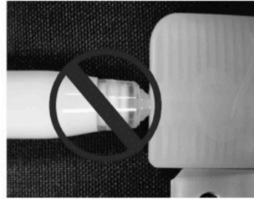
Figur 5: Pipettspets felaktigt isatt i injektionsporten.
