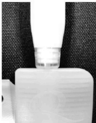
Figur 4: Pipettspets riktigt isatt i
