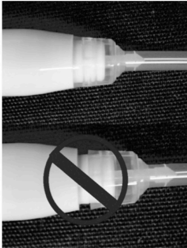
Figur 2: FELAKTIGT kontra RÄTT sittande pipettspets på pipetten.
